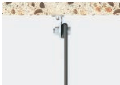
3. terhelési eset: szerelőszalag akasztófűlre rácsavarozva, visszahajtott szalagvég, szabad szalagvég belül minimális törőerő az A oszlop szerint
