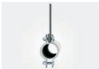
10. terhelési eset: szalagvég a csőbilincsre rácsavarozva és visszahajtvva minimális törőerő az A oszlop szerint
