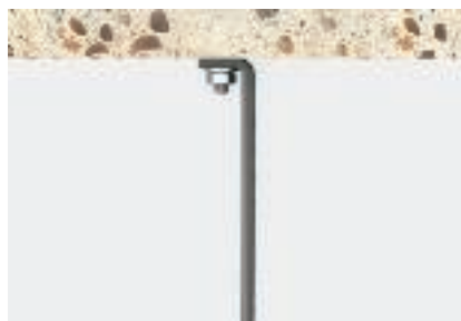
4. terhelési eset: csavarral és alátéttel a mennyezet alá csavarozva minimális törőerő a C oszlop szerint
